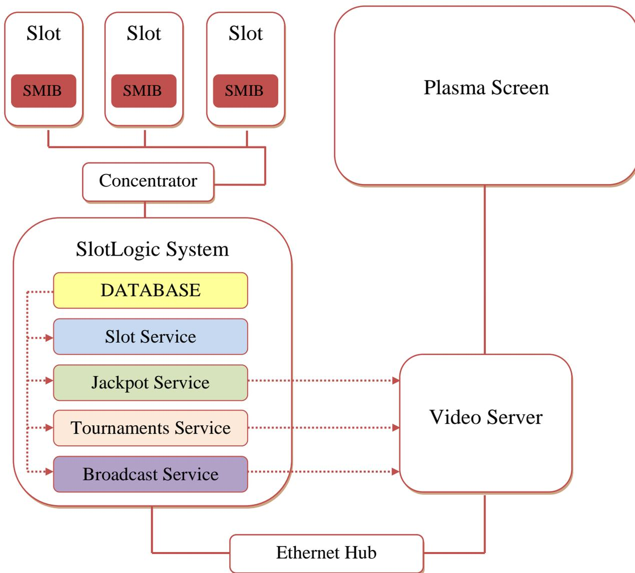
Схема взаимодействия видео сервера с системой «SlotLogic».
